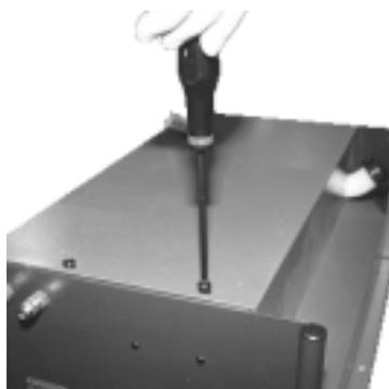
Démonter les 4 vis cruciforme sur le dessus du RF 350.
