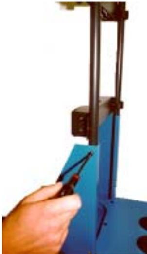
2°) Enfiler l'arceau cale bouteille dans les encoches du chariot.
