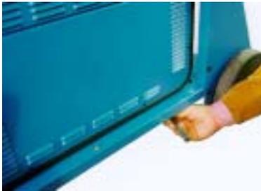
Poser le CYTIG 532 MP sur la plate-forme en engageant les têtes de vis dans les boutonnières.
