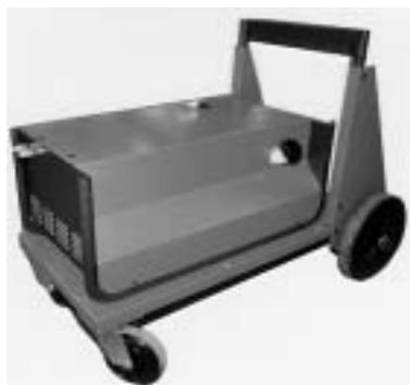
Poser le RF 350 sur la plate-forme en engageant les têtes de vis dans les boutonnières.
