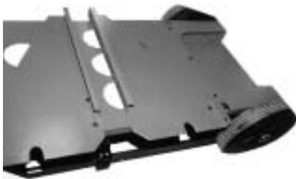
1°) démonter les 2 supports arceau cale bouteille de gaz
