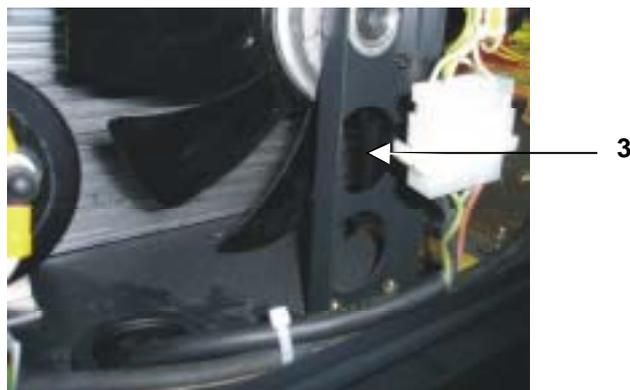
3 - Clipser l'ensemble du connecteur sur le trou du support ventilateur
